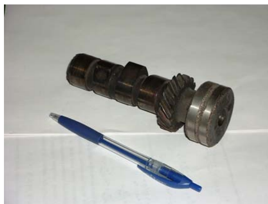
Рис. 7. Распределительный вал ДВС после ремонта методом электроннолучевой наплавки
