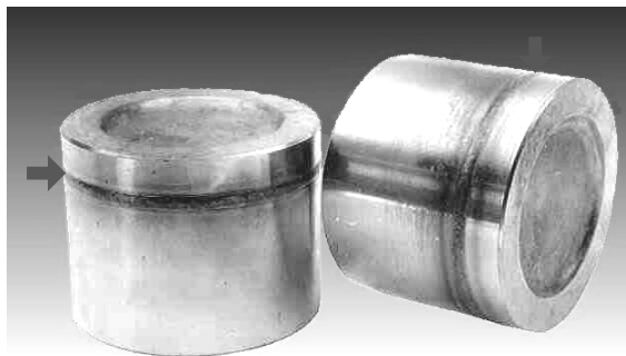
Рис. 2. Заготовки поршней из сплава АК21М2,5Н2,5 с упрочненными зонами под роточку кольцевых канавок (показаны стрелками)
